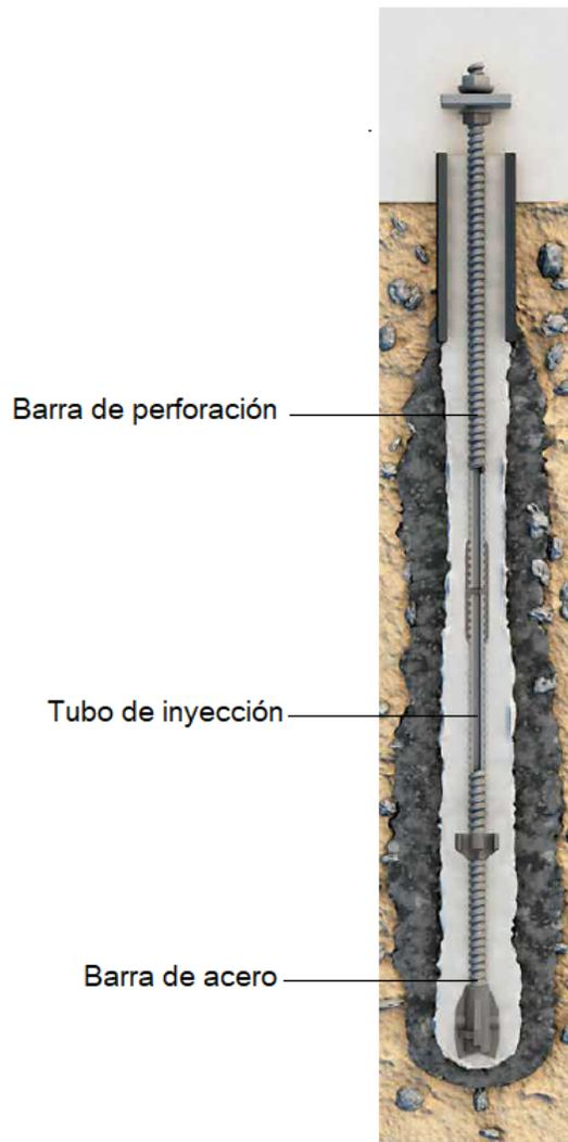
Figura 1.5: Esquema micropilote. <sup>9</sup>
