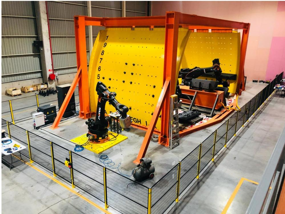
*Ilustración 20 Maqueta actual en laboratorio para molino SAG*
