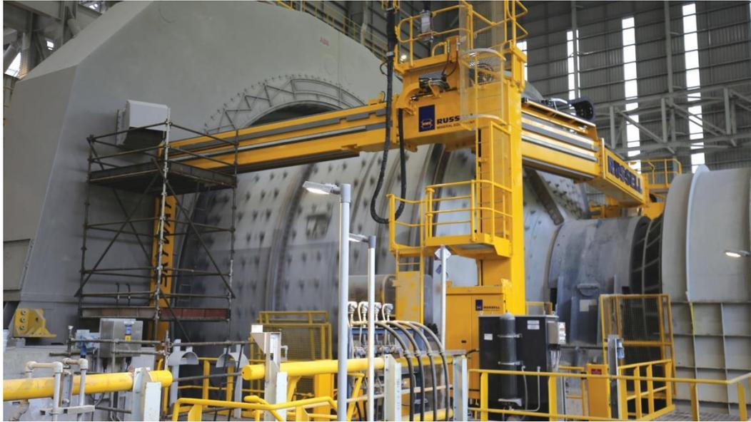
*Ilustración 17 Implementación de skyway en faena de Cobre Panamá*
