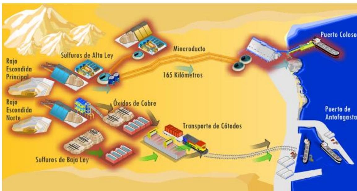
Ilustración 2 Diagrama General del proceso productivo de Minera Escondida
