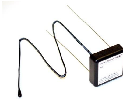
Figura 4: Sensor de madurez inalámbrico.
