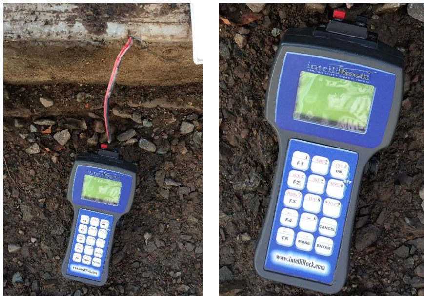
Figura 5: Dispositivo Intellirock, y conexión con sensor.
