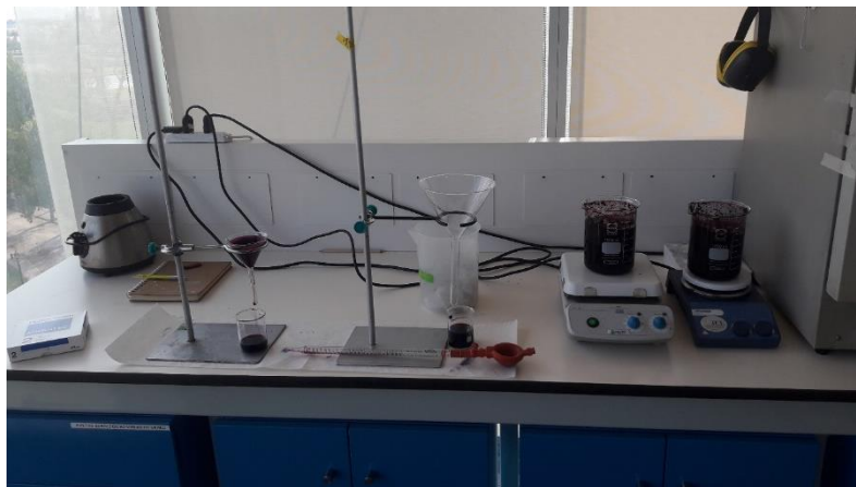
Figura 11. Set experimental para la medición de actividad de \beta -glucosidasa en el maqui. A la derecha placas magnéticas para agitación de jugo de maqui y tratamiento con shock de calor. A la izquierda sistema de filtración de jugo de maqui para posterior análisis por HPLC.
