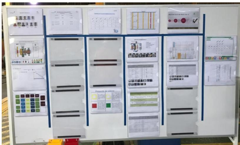
*Ilustración 44: Pizarra con indicadores clave para el control del rendimiento de las máquinas, controlando manualmente por gestión visual del operador de la máquina indicadores de calidad y eficiencia. En dicha pizarra se incluyen también directrices para la producción y pasos para implementación de metodologías 5s*
