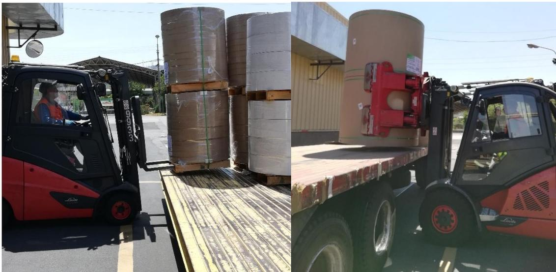
*Ilustración 28: Grúas horquilla y mordaza respectivamente. Tienen como finalidad el desplazamiento de los insumos, productos y recortes dentro del área de conversión y también el proceso de carga y descarga de los colosos.*
