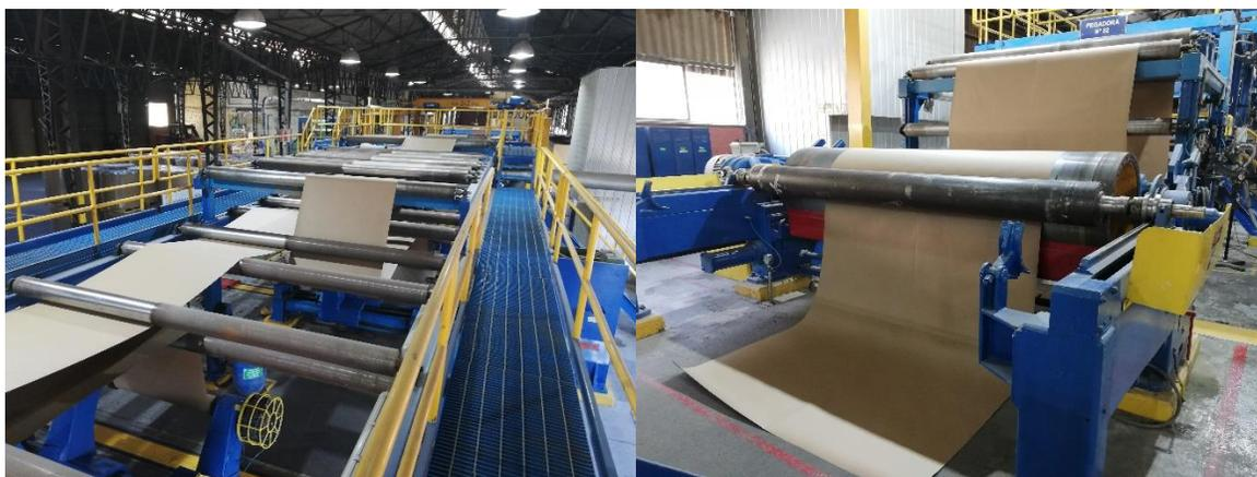
*Ilustración 21: Máquina pegadora 82. Se puede apreciar en la imagen de la izquierda la vista superior de la máquina, donde se observa la serie de polines enhebrados con el papel proveniente de 2 diferentes rollos de consumo. Al costado derecho se aprecia la salida de la pegadora donde se observa el papel ya pegado, en condición inicial para ser bobinado en pope antes de pasar a máquina bobinadora 41.*
