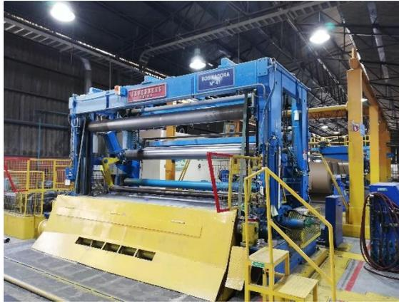
*Ilustración 23: Bobinadora 41. Esta bobinadora se dedica únicamente al proceso de rebobinado de producto de la pegadora 82.*
