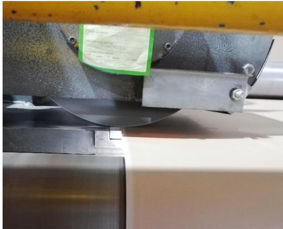
*Ilustración 34: desgaste por esmerilado de orilla del papel a ser pegado mediante el roce con un metal en rotación*
