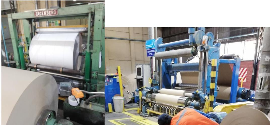
*Ilustración 24: Bobinadoras 42 y 43. Ambas bobinadoras tienen capacidad de ancho de 127 cm y producen principalmente rodelas.*
