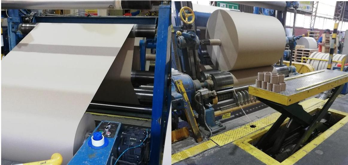
*Ilustración 31: Bobinadora 43. A la izquierda se muestra la parte trasera donde ingresa un rollo para consumo (para ser desenrollado) mientras que a la derecha se muestra la parte delantera, donde se observa el rollo resultante. En este proceso de bobinado, se realizó además un proceso de corte, como se verá en ilustración 17*
