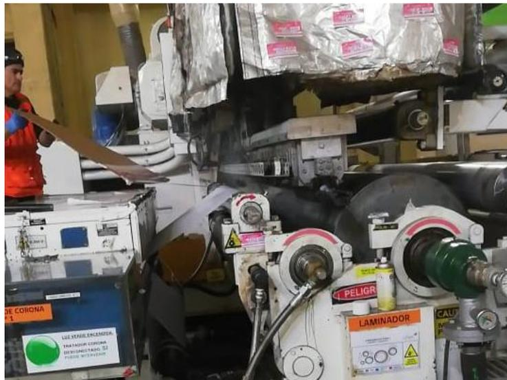
*Ilustración 37: Carro extrusor, encargado de laminar el papel. En la imagen se muestra el carro extrusor dejando caer lámina derretida de plástico sobre el papel microperforado por la máquina que se observa al costado izquierdo*
