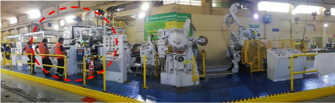
*Ilustración 36: Máquina extrusora 11 en funcionamiento. Al costado izquierdo se encuentra el ingreso de rollos para procesar y al costado derecho salen los rollos terminados. En círculo rojo se observa el carro extrusor, donde se aplica el film de plástico, visto en más detalle en Ilustración 21*
