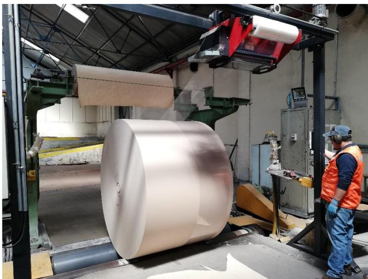
*Ilustración 26: Embaladora 71. La embaladora permite embalar con film plástico y caras de cartón en los costados aquellos rollos de mayor tamaño cuyo destino es principalmente la exportación.*
