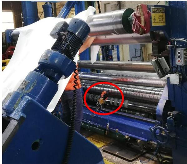
*Ilustración 32: La imagen corresponde a un operario enhebrando la bobinadora 41. Encerrado en el círculo rojo se observa cuchilla circular, que realizará el corte establecido al papel*
