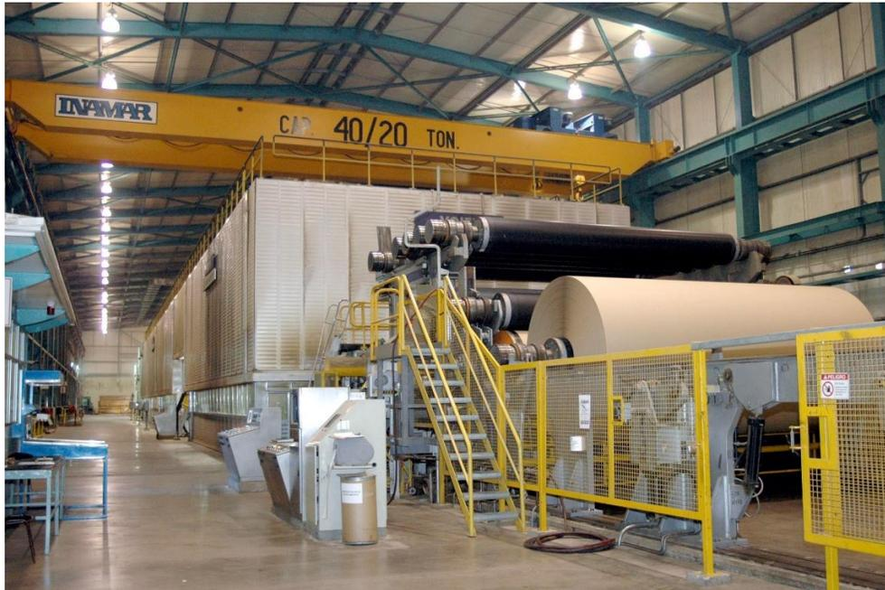
*Ilustración 13: Máquina semi-autónoma de producción de papel de operación continua en proceso de generación de rollo de papel. Al fondo de la sala ingresa la fibra como un chorro de agua en forma de lámina, en el intermedio se aplica vapor y presión mediante rodillos, y al final (costado derecho) se bobina el rollo de fibra resultante.*
