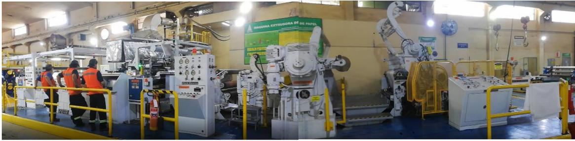
*Ilustración 22: Máquina extrusora 11. Se aprecia de izquierda a derecha la zona de carga de rollo de consumos, zona de corriente para aumentar adherencia, zona del carro extrusor (dedicado a verter lamina de resina), hasta la salida del rollo.*
