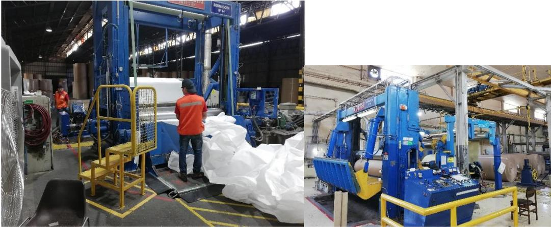
*Ilustración 25: Bobinadoras 44 y 46. Ambas bobinadoras tienen capacidad de anchos más grandes que las bobinadoras 42 y 43.*
