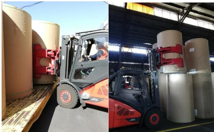
*Ilustración 39: Ingreso de rollos de consumo a almacén del área de conversión. La labor es realizada por la grúa “mordaza” que se ve en la imagen. Esta es capaz de movilizar un máximo de 2 rollos simultáneamente.*
