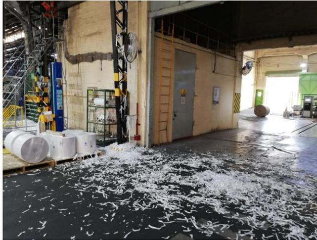
*Ilustración 43: Problema por ductos obstruidos. En la esquina superior izquierda se observa persona limpiando los ductos, lo que puede llevarle entre 10 a 15 minutos). Lo anterior deja paralizada las bobinadoras 42 y 43 por el periodo que dure la reparación, y ensucia la zona de trabajo y maniobra de grúas*
