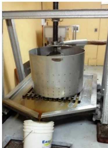
Figura 3: Prensa de acero inoxidable utilizada por Nahuelbuta Verde para extraer el zumo de manzana de la pulpa.
