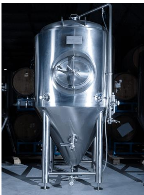
Figura 22: Fermentador alcohólico genérico, con intercambiador de calor tipo chaqueta y fondo cónico [44].
