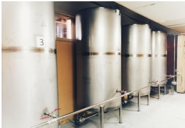
Figura 4: Estanques de acero inoxidable empleados en la fermentación acética dentro de la planta Nahuelbuta Verde.
