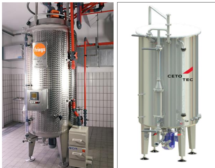
Figura 23: Fermentadores acéticos fabricados por las compañías Frings (izquierda) y CETOTEC (derecha). En la base cuenta con un aireador para la oxigenación del fluido además de un sistema para el control de temperatura [45].
