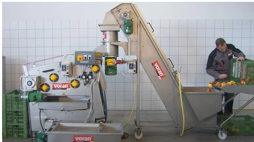
Figura 21: Equipo Voran Maschinen modelo EBP500 para extracción del zumo de manzana. Incluye las operaciones de lavado, molienda y prensado, listadas de derecha a izquierda.
