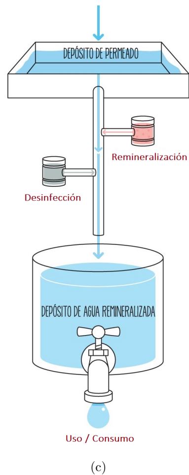
Figura 2.1: Infografía del funcionamiento de una planta desalinizadora extraído de Acciona.
