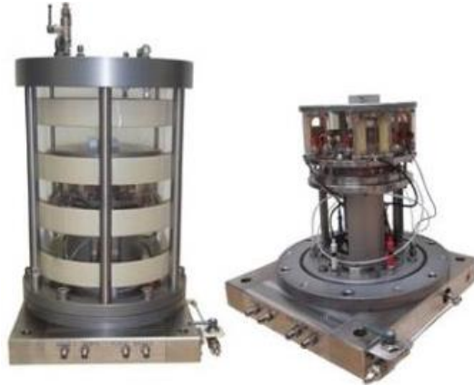
Figura 3-16: Cámara Triaxial y componentes internos Columna Resonante. (GDSELAB v2.5.4, 2015).
