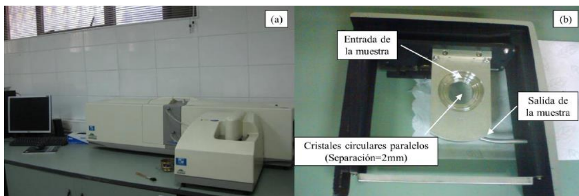
Figura 3-5: Equipo de análisis granulométrico. (a) Equipo Mastersizer 2000. (b) Sistema de circulación de mezcla arena-solución (Maureira, 2012).
