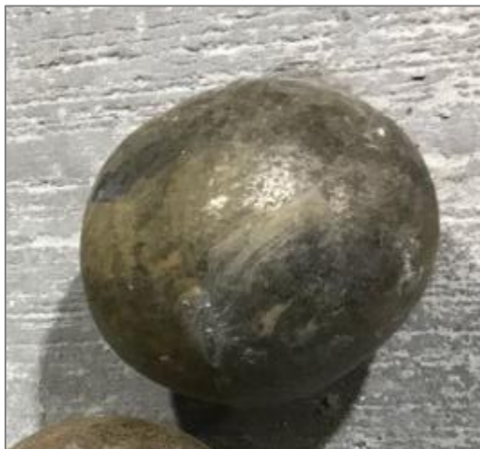
Figura 12: Bola de acero 5" deformada. Fuente: confidencial.
