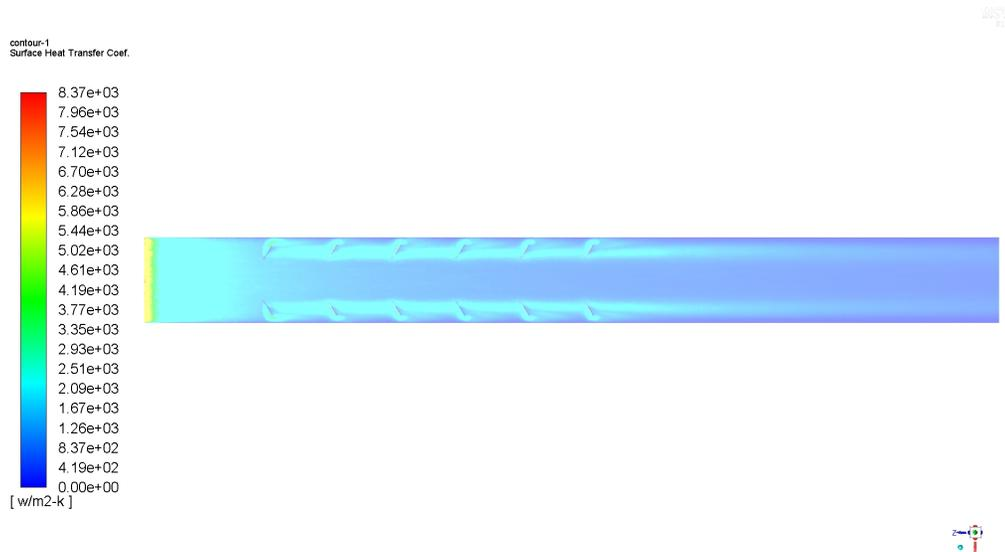
Figura 4.42: Mapa de coeficiente de transferencia de calor ' $h$ ' a lo largo de la pared inferior del canal.
