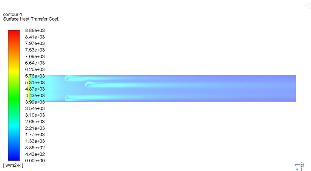
Figura 4.30: Mapa de coeficiente de transferencia de calor ' $h$ ' a lo largo de la pared inferior del canal.
