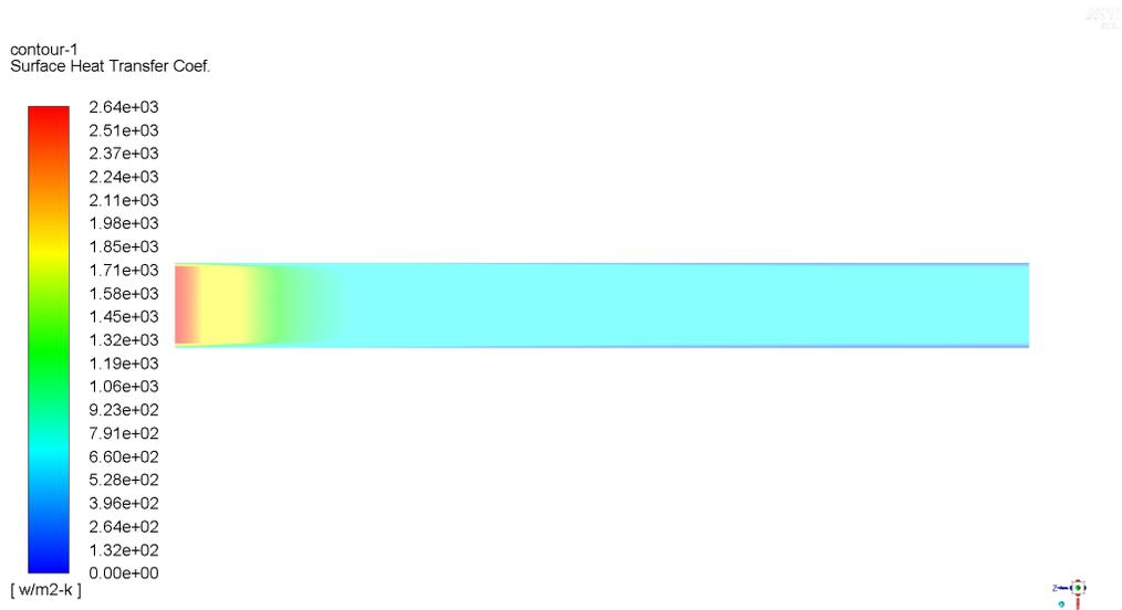
Figura 4.2: Mapa de coeficiente de transferencia de calor 'h' a lo largo de la pared inferior del canal.
