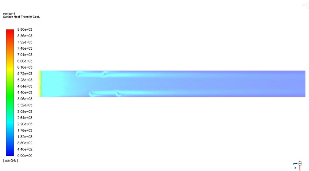
Figura 4.34: Mapa de coeficiente de transferencia de calor ' $h$ ' a lo largo de la pared inferior del canal.
