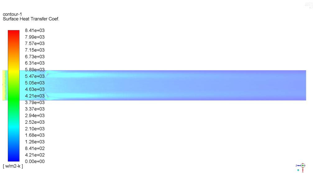
Figura 4.26: Mapa de coeficiente de transferencia de calor ' $h$ ' a lo largo de la pared inferior del canal.
