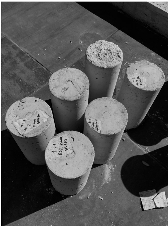
Img. 13 y 14 Proceso de mezclado y probetas recién desmoldadas respectivamente. Fuente: Elaboración propia.
