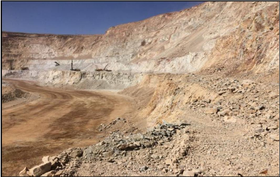
Figura N°6-36 Avance de pala, sin rematar línea de programa (LP).
