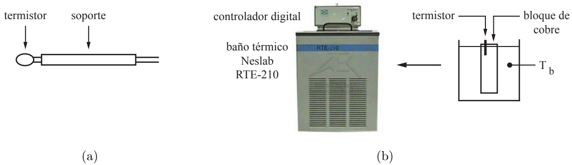
Figura 4.10: Calibración de termistores. (a) Esquema de los termistores fabricados. (b) Método de calibración. Los termistores se ubicaron al interior de un cilindro perforado de cobre y este último al interior del baño térmico Neslab RTE-210, cuya temperatura T_b se ajusta mediante controlador digital de este equipo. La calibración se realizó imponiendo la temperatura de trabajo del baño térmico en rango T_b \in [14, 30] °C.
