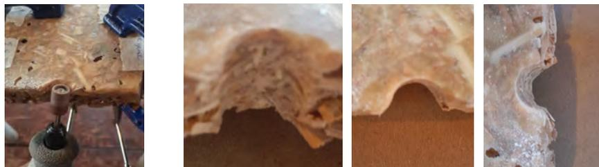
Figura 127. Prueba de trabajabilidad, lijado. Propiedad del autor. 2020.
