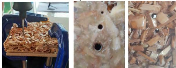
Figura 126. Prueba de trabajabilidad, perforación. Propiedad del autor. 2020.
