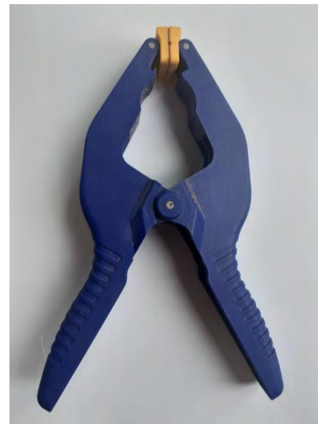
Figura 79. Prensa tipo pinza.
