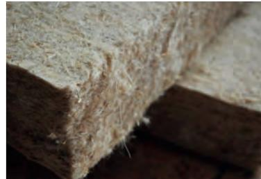
Fibras de madera de poda y limpieza. Paneles de aislamiento.
