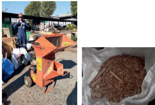
Figura 106. Chipeado del material.
