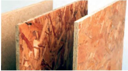
OSB (Oriented strand board) de virutas. Paneles estructurales.
