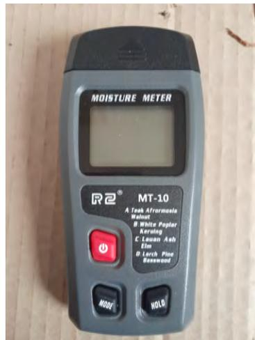
Figura 62. Medidor de humedad para maderas. Propiedad del autor. 2020.
