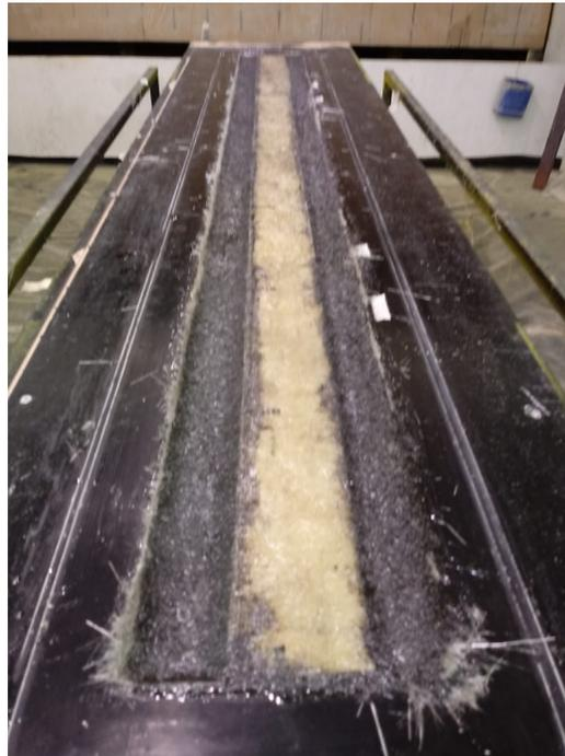
Figura 5.3: Ensamble del nucleo de espuma y última capa separadora-alma.
