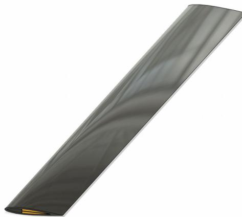
Figura 5.7: Geometría de la pala sin daño.
