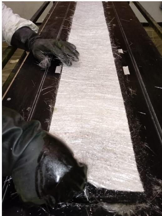
Figura 5.1: Colocación de primeras capas de MAT450 sobre resina Palatal A430.
