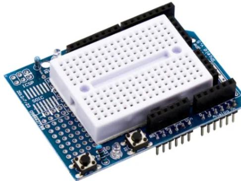
Figura 5.1: *Shield* de prototipado compatible con Arduino UNO. Fuente: [49]
