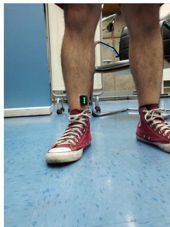
(a) Posicionamiento IMU MPU6050
