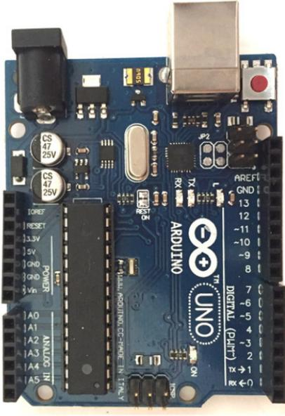
Figura 4.1: Arduino UNO. Fuente: [42]
