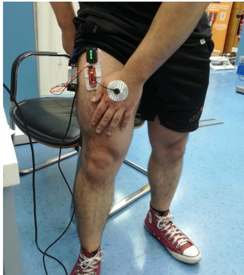
Figura 4.22: Calibración del sensor - Posicionamiento de electrodos y módulo Delsys para medición de EMG
