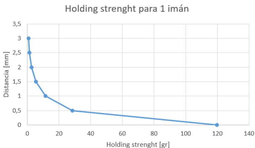
Figura D.1: *Holding strenght* para un único imán. Fuente: Elaboración propia.
