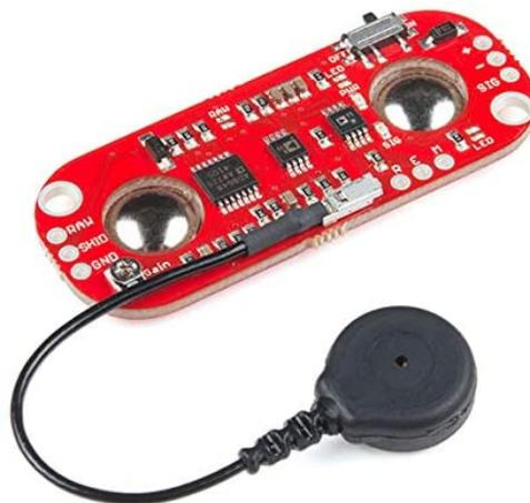
Figura 2.16: Sensor sEMG AT-04-001 compatible con Arduino. Fuente: [33]
