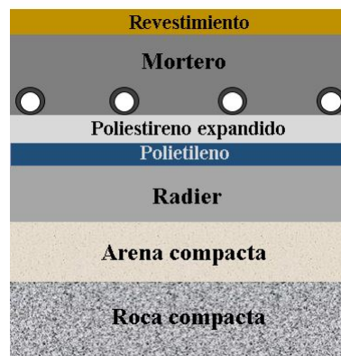
Figura 4.11: Elementos del piso radiante
