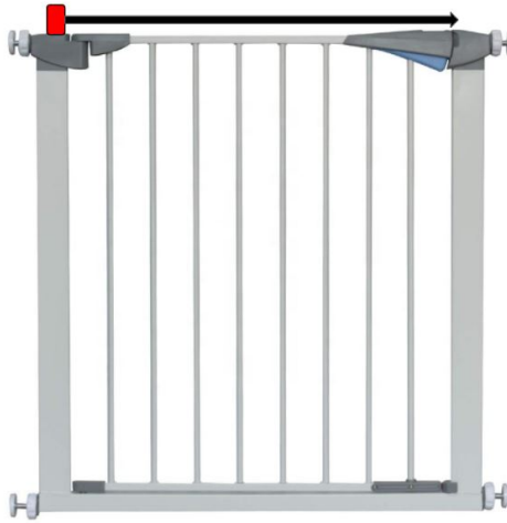
Figura 4.10: Esquema de implementación del sensor ultrasónico (en rojo) para la medición del escenario 2.
