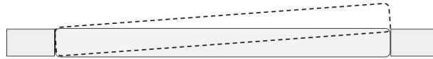
Figura 4.7: Esquema de utilización del sensor de ángulo para la detección del escenario 1. El esquema corresponde a una vista superior de la puerta base.
