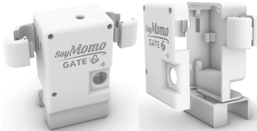
Figura 4.21: Renderización del diseño de la carcasa para la implementación basada en el Arduino Pro Mini, con batería recargable.
