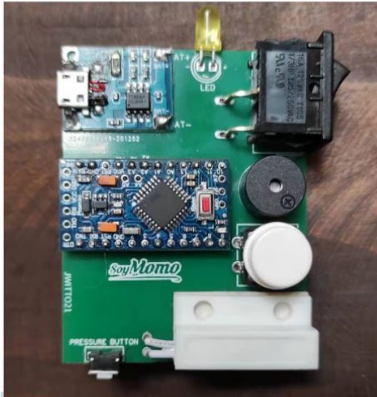
Figura 4.19: Implementación final del sistema embebido basado en microcontrolador Arduino en placa PCB.
