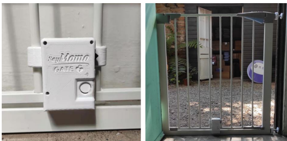
Figura 4.23: Integración del sistema embebido, a través de su carcasa de contención, con la puerta base. A la izquierda, el detalle de la integración, realizada en la parte inferior de la puerta base, con el sistema embebido instalado en la parte móvil. A la derecha, la visión completa del producto final.
