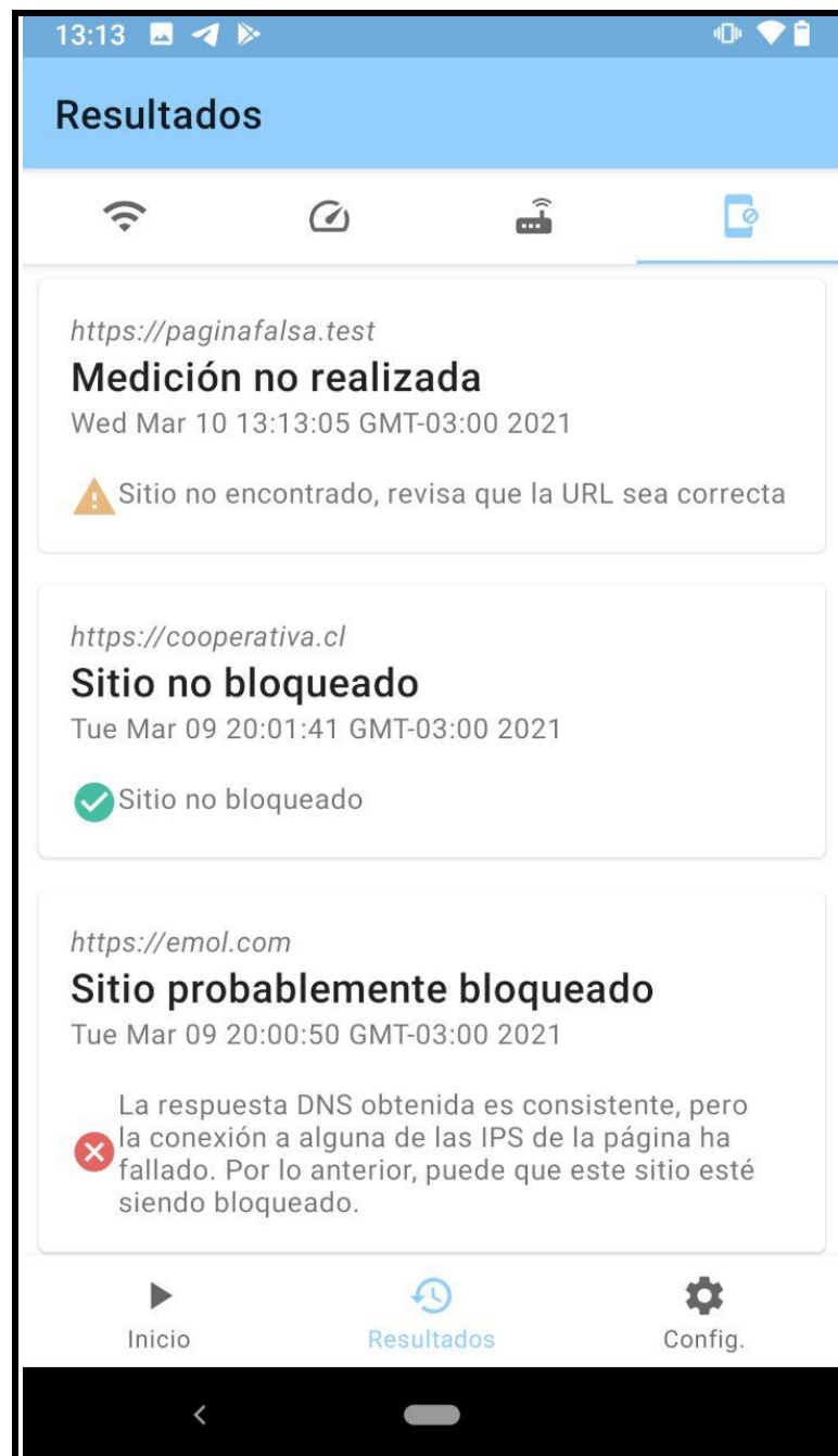
Figura 3.16: Pantalla de Resultados de la Medición de Detección de Bloqueo de Sitios Web de la Aplicación. El supuesto bloqueo del sitio https://emol.com/ ocurre debido a que OONI no puede conectarse a las IPs dadas por la consulta DNS. Cabe señalar que no existen problemas de conexión para los casos de http://emol.com/ , https://www.emol.com/ y http://www.emol.com/ .
