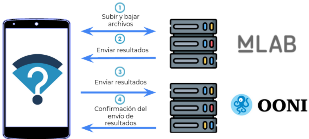
Figura 3.5: Para realizar esta medición se utiliza un servidor de M-Lab, desde el cual se descargan y suben archivos para obtener la velocidad de subida y bajada de la red. Una vez terminada esta medición, M-Lab envía los resultados a la aplicación, la que luego los envía OONI.
