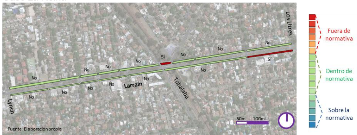
Figura 27. Comparativa de pendiente longitudinal de veredas en tres tramos. Elaboración propia
