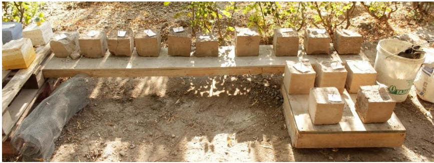
Figura 122. Test de Carazas. Fuente: Elaboración propia
