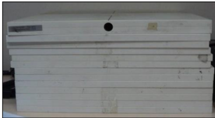
Figura N°8: En la imagen se observa el fantoma de placas PMMN de RW3 que se usará para irradiación de películas radiográficas.
