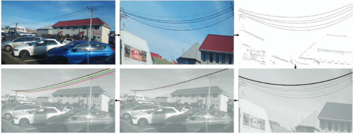
Figura 2.32: Método utilizado para detectar líneas de la red eléctrica [43]
