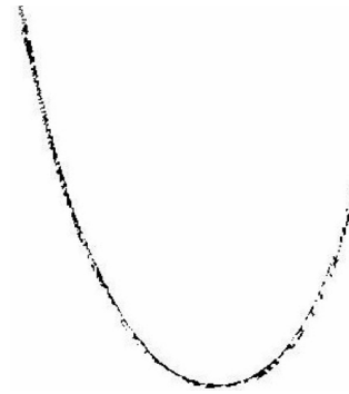
b Imagen binaria del perfil del cable
