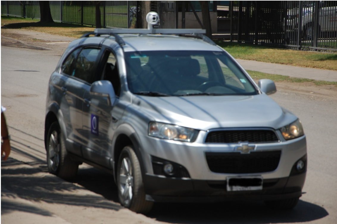
Figura 3.1: Vehículo con la cámara instalada para obtener videos del recorrido. [Original de los autores, 2020].
