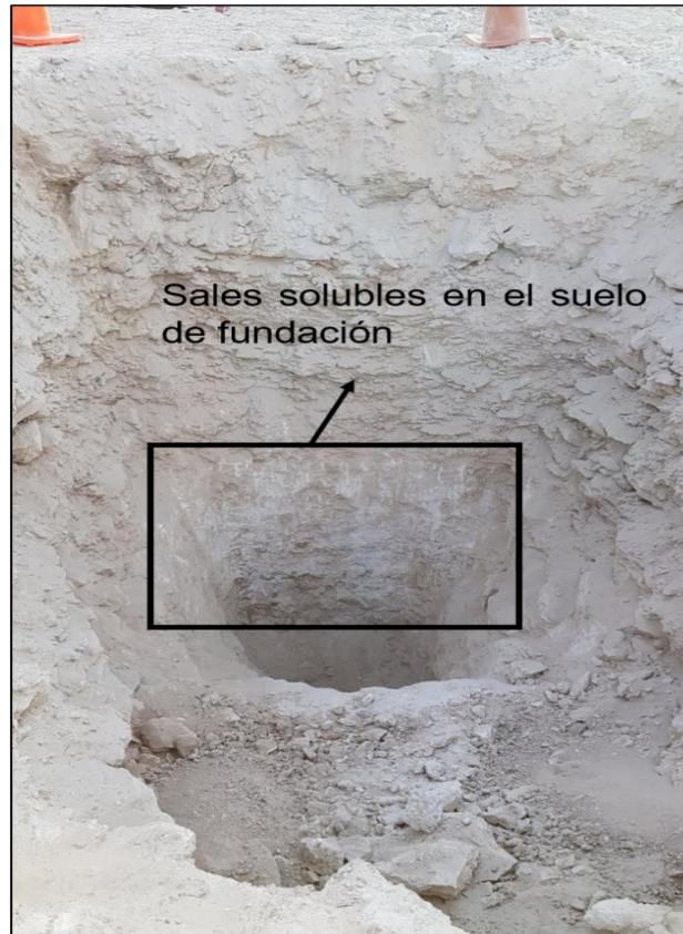
Ilustración 14. Calicata en terreno donde se aprecia el contenido salino en el suelo de fundación en forma de costras blancas. (IDIEM, 2020)
