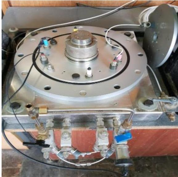
Figura 10.26. Base de la columna resonante.
