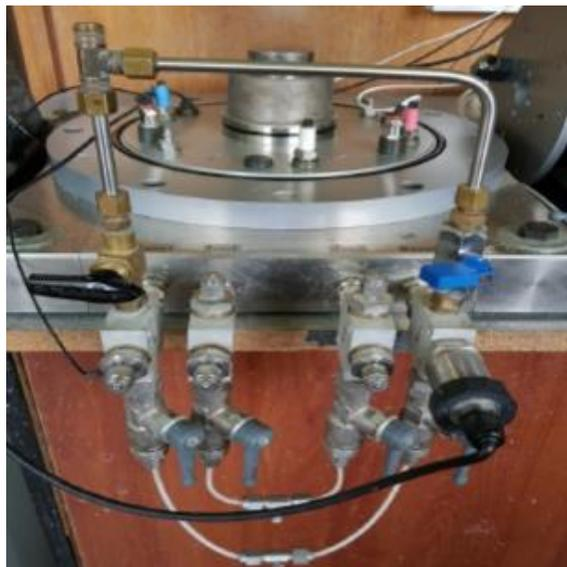
Figura 20.27. Conexiones de mangueras al cap superior e inferior de la probeta.
