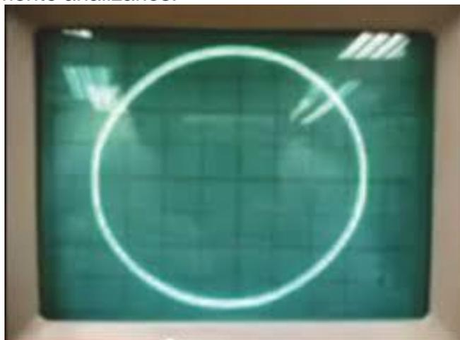
Figura 10.23. Figura de Lissajous vista en osciloscopio para un desfase de 90°.
