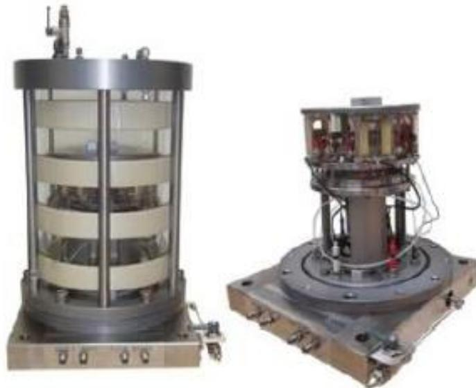
Figura 10.22. Cámara Triaxial y componentes internos de la Columna Resonante.
