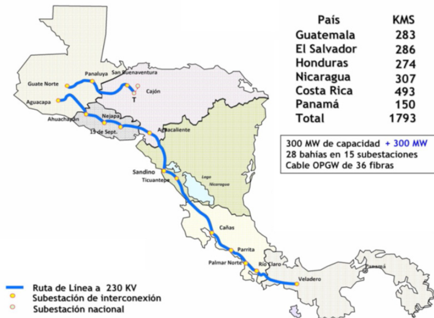
Figura 2.4: Sistema de Interconexión América Central - SIEPAC [24].
