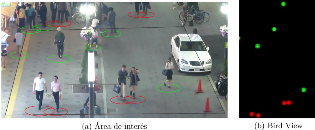
Figura 4.13: Ejemplo de detección de peatones y mapeo correspondiente en su *Bird View*
