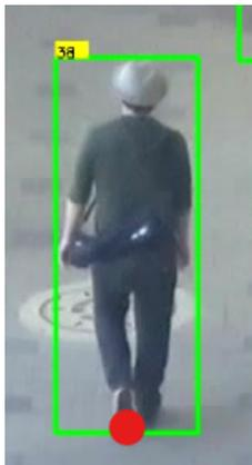
Figura 4.12: Pies de la detección: Punto medio del lado inferior del *bounding box*
