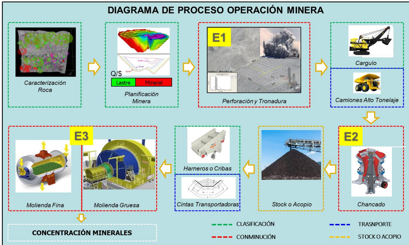
Figura 13.- Diagrama proceso operación Mina & Planta, donde “E” corresponde a la energía requerida para las etapas de conminución.
