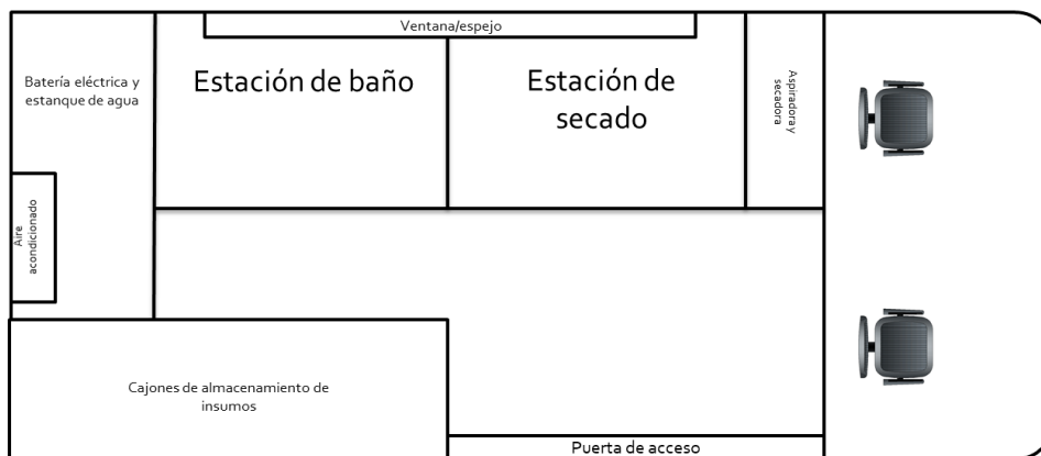
Figura 19: Layout del vehículo Fuente: Elaboración propia
