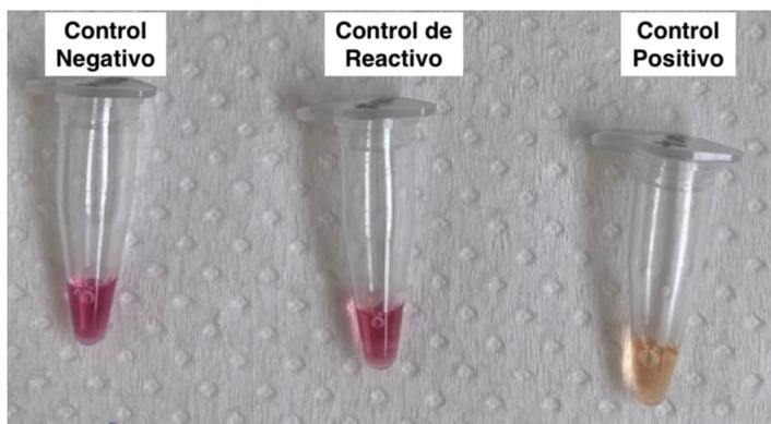
Figura 2.14: Tubos de reacción LAMP, con rojo fenol.
