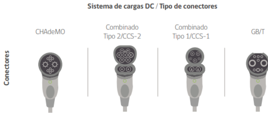
Ilustración 9: Tipos de conectores según sistema de carga Fuente: Guía Buenas Prácticas Electromovilidad – Ministerio de Energía
