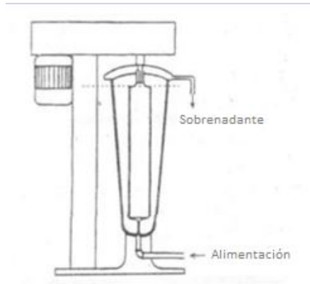
Figura 7.1: Centrífuga sedimentadora de tipo tubular [116].
