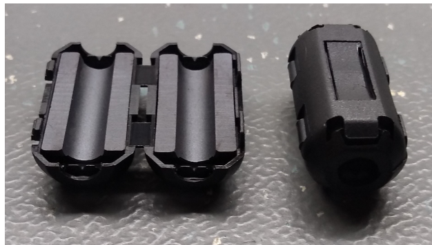
Figura 3.14: Ferritas utilizadas en los cables de polarización.
