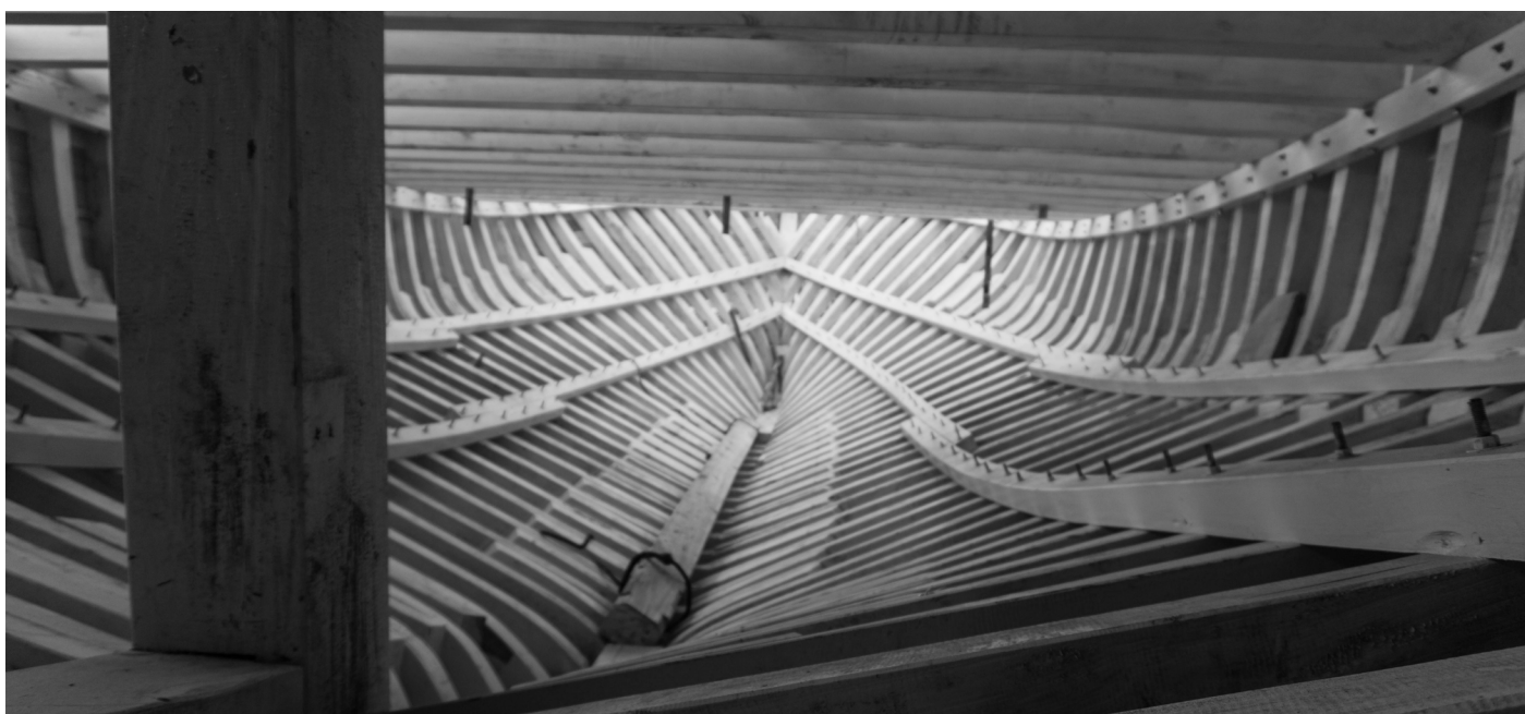
Fig 7. Estructura de un bote realizado a mano por carpinteros de ribera en San Juan, Dalcahue
