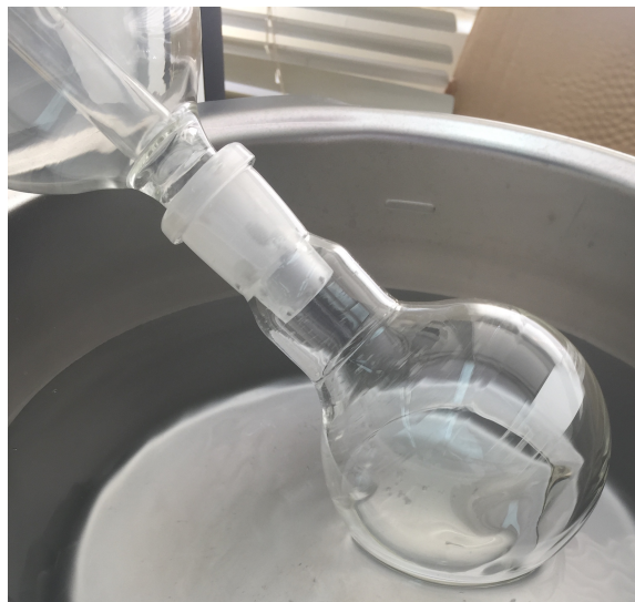
Figura B.5: Líquido iónico concentrándose en rotavapor.
