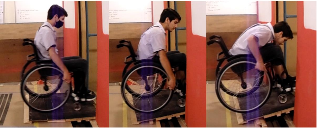
Ilustración 12-III: Diferencia de postura al realizar maniobra para diferencias de nivel de 3 cm, 10 cm y 18 cm silla urbana.
