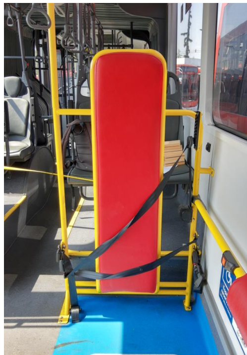
Ilustración 1.4-II: Apoyo espaldar Scania Caio Mondego.
