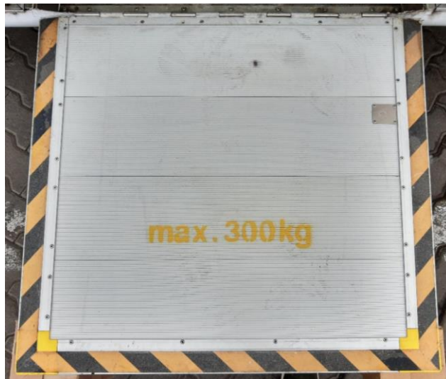
Figura 15: Rampa con biselado en los costados Marcopolo Superpolo Viale BRT.
