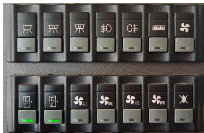
Ilustración 1.9-V: Botones operación Foton eBus 12SC.
