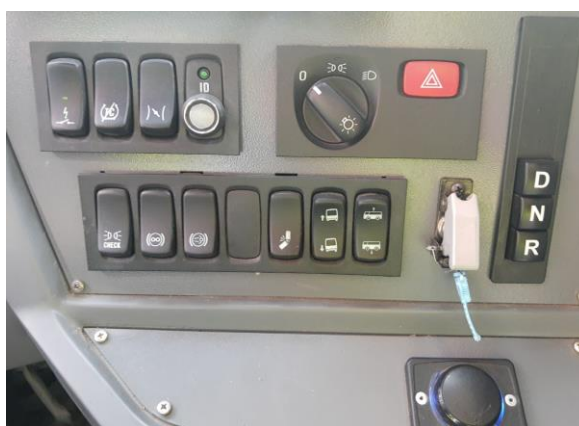
Ilustración 9.4-IV: Botones operación Scania Caio Mondego.
