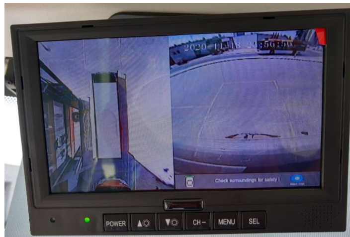
Ilustración 1.9-IV: Visión cámaras exteriores Foton eBus 12SC.
