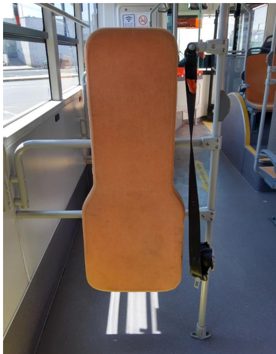
Ilustración 10-II: Apoyo espaldar Yutong ZK6128BEVG.
