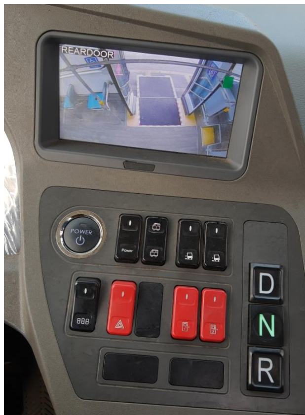
Ilustración 1.7-IV: Visión cámara y botones operación BYD K9FE.
