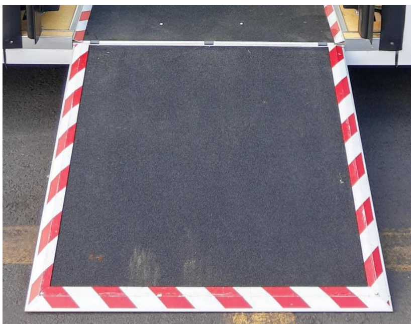
Figura 11: Rampa con bordes laterales biselados modelo BYD K9FE.
