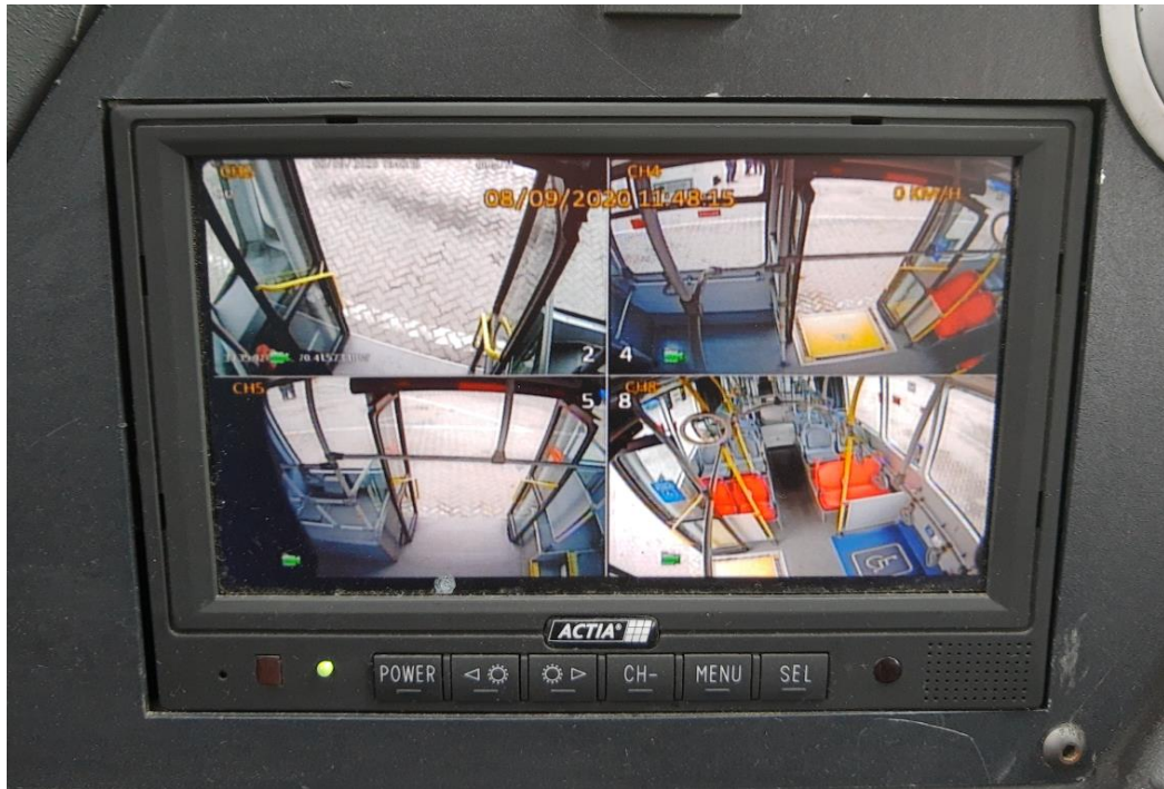
Ilustración 1.8-IV: Visión cámaras Volvo Marcopolo Superpolo Viale BRT.
