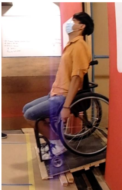
Ilustración 12-VII: Inclinación para compensar bajada en rampa 70 cm y 22cm de desnivel.
