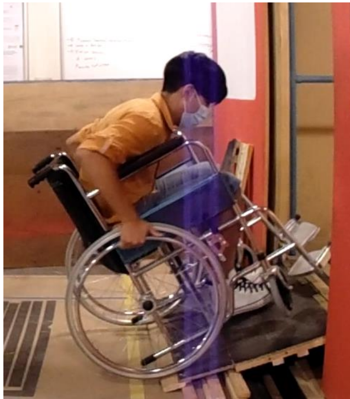
Ilustración 12-IV: Ruedas delanteras alzadas por causa de diferencia de nivel de 22 cm con rampa 70 cm en silla ortopédica.
