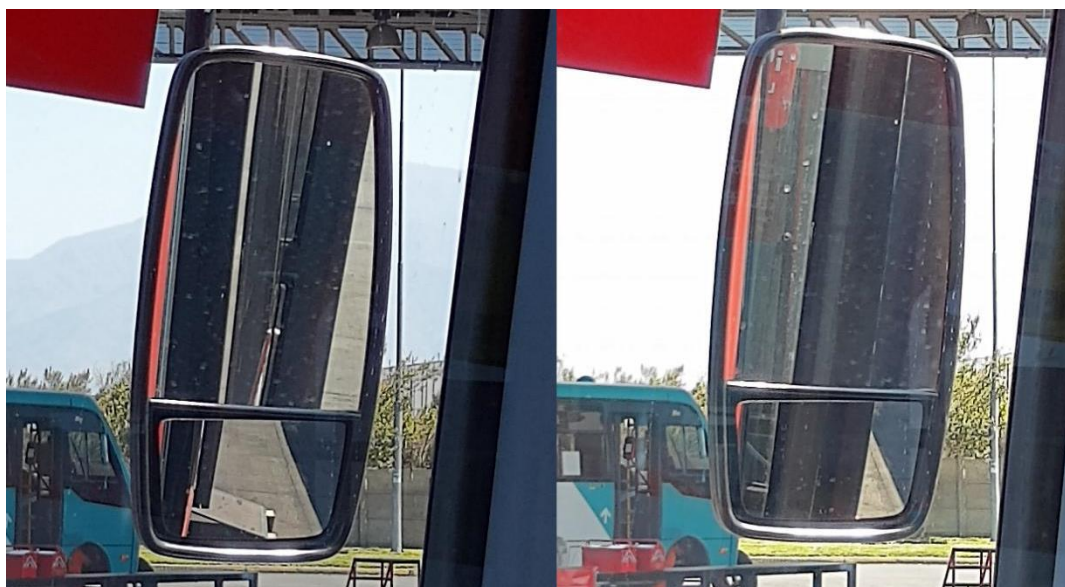
Figura 12: Pérdida de visión de rampa con primera puerta cerrada y abierta respectivamente.
