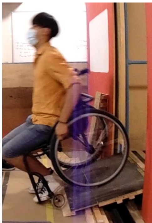
Ilustración 12-VIII: Ruedas traseras levantadas por golpe del soporte para pies en silla urbana con rampa de 70 cm y diferencia de nivel de 22 cm.
