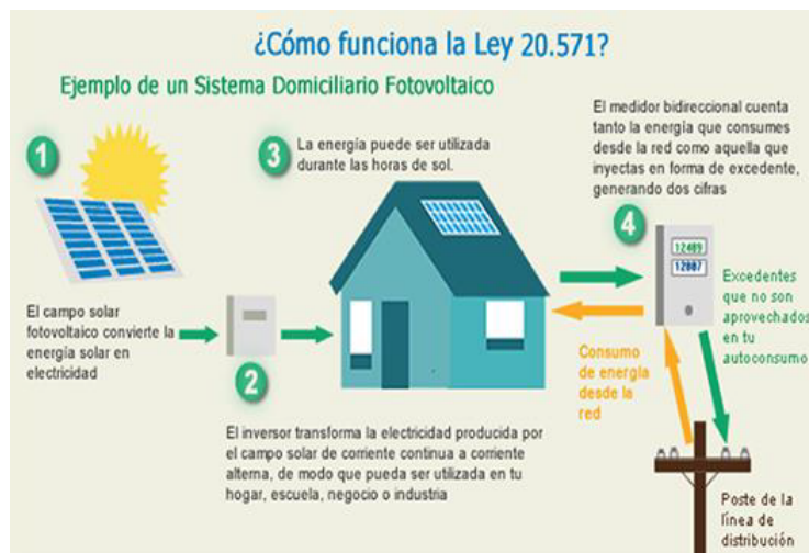
Figura 2.6: Funcionamiento ley generación distribuida [19].
