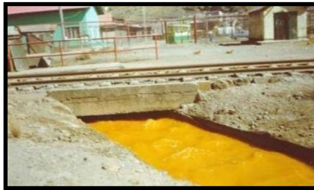
Figura 2.17 Canal con efluente del Túnel Kingsmill.
