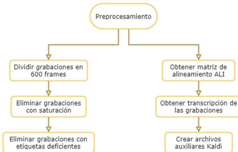
Figura 4.2: Diagrama de la metodología seguida para el preprocesamiento
