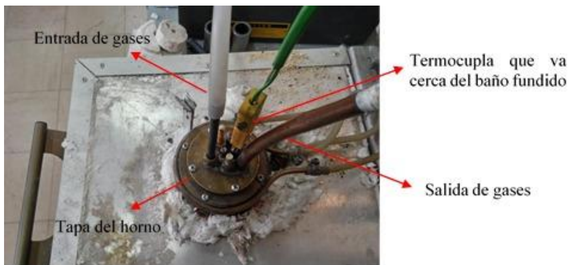
Figura 43. Tapa de tubo de reacción en el horno eléctrico
