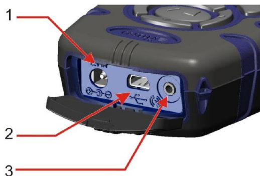
Figura 98: Outputs del sistema. (1) Conector de energía 12 VDC. (2) Conexión USB micro B. (3) Salida analógica 2,5mm. [42]
