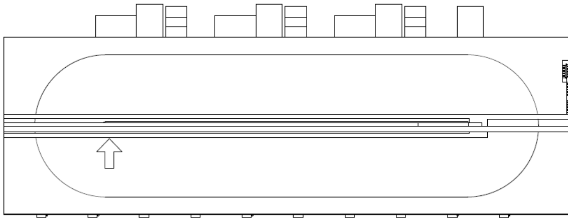
Figura 100: Layout de localización de sensor de polvo. Vista en planta.
