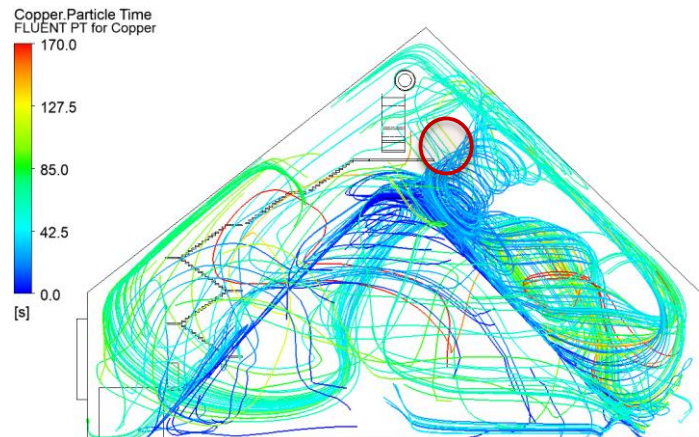
Figura 71: Tiempo de residencia de partículas caso 8,5 m/s Noroeste con 1 filtro de manga. En el círculo indicado se tienen zonas de baja circulación, de las figuras 65, 66 y 67.
