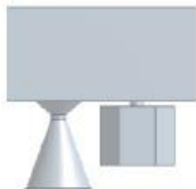
Figura 110. Diferentes formas de cavidad para el diseño de un resonador de Helmholtz. Fuente: Pisarev, Anoshkin & Akhunzianova (2020) [45].
