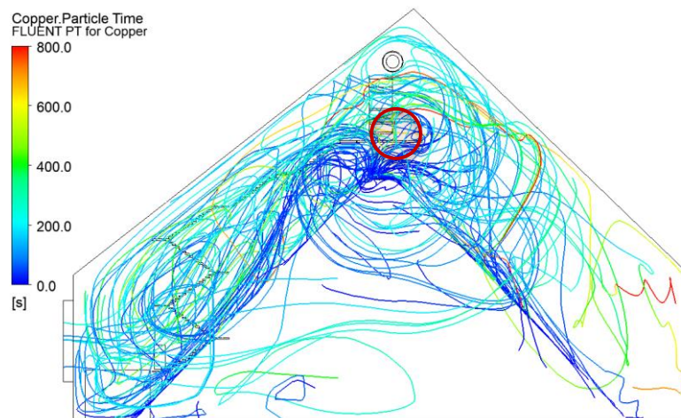
Figura 69: Tiempo de residencia de partículas caso base con 1 filtro de manga. En el círculo indicado se tienen zonas de baja circulación, de las figuras 65, 66 y 67.
