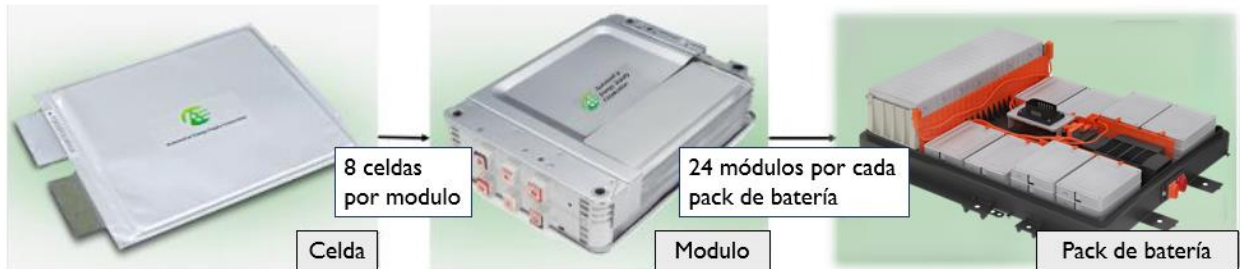
Ilustración 2.7 Organización de las celdas de batería del Nissan Leaf
