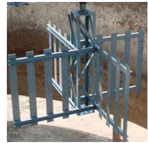
(d) Imagen de un floculador mecánico de eje vertical de paletas (Suárez et al., 2014).
