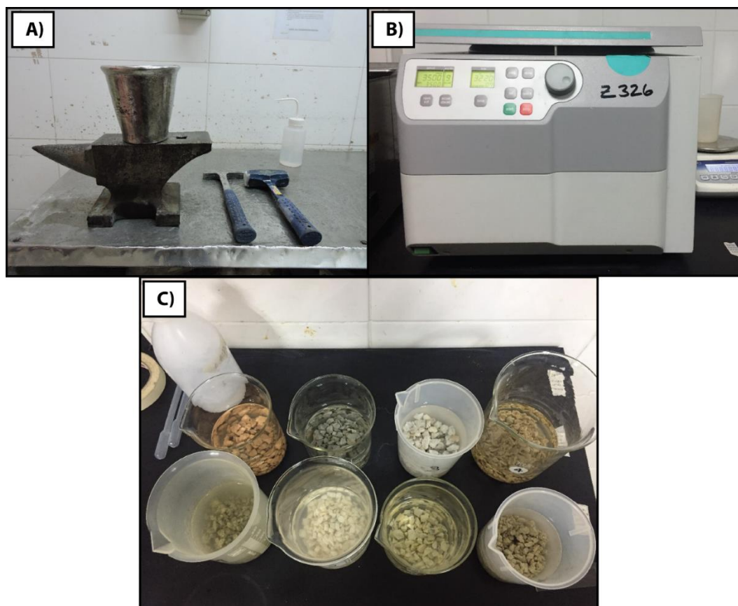
Figura 9. Proceso de separación de la fracción <2 \mu\text{m} . (A) Disgregación con martillo y mortero de acero inoxidable; (B) centrífuga Hemle Z 326; (C) muestras disgregadas en 200 mL de agua ultrapura, con adición de dispersante.
