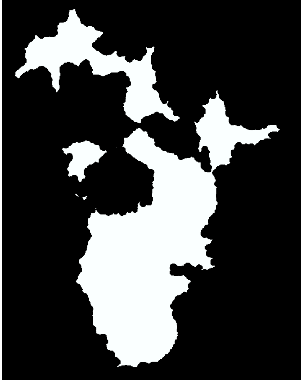
Figura 6.10: Mapa obtenido de la diferencia entre un mapa modificado usando los métodos definidos en Poblete y col. 2021 y un mapa modificado usando la aplicación desarrollada en esta memoria. La altura de los puntos fue modificada de su altura original hasta una altura entre 500 y 780 metros. En negro, puntos del mapa que poseen un valor 0 de altura. En blanco, puntos del mapa que poseen un valor distinto de cero. Todo el resto del mapa corresponde a puntos en color negro.
