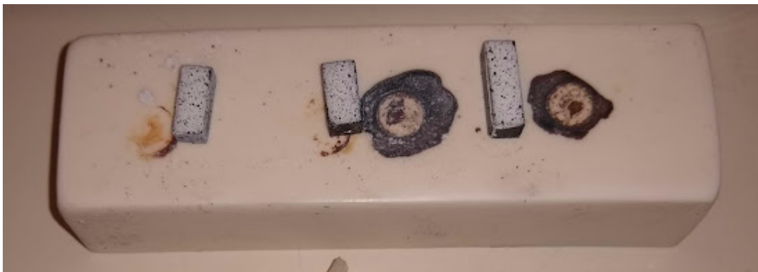
Figura 4.1.6: Aplicación moteado sobre LSCF, Pyro-Paint™ 634-SIC
