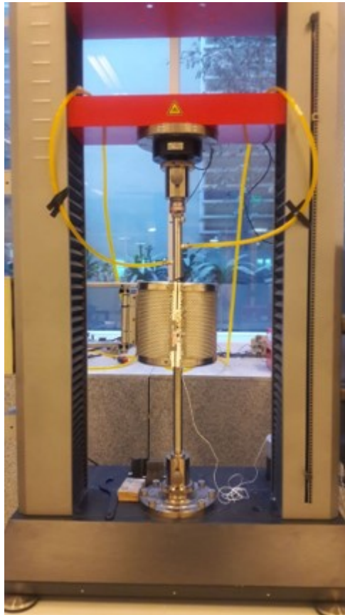
Figura 4.2.1: Máquina de ensayo Zwick/Roell Z100 equipada con horno tubular de alta temperatura, rango 25°C a 1100°C
