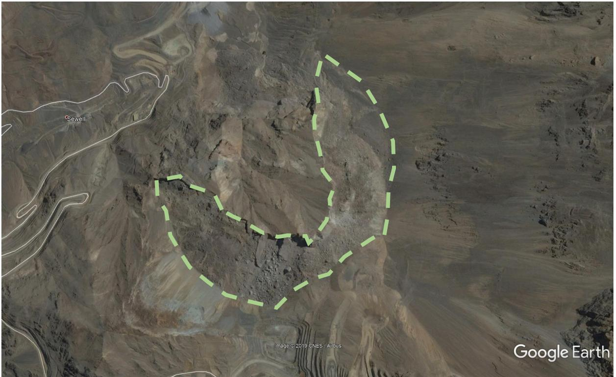
*Ilustración 26 Influencia en superficie de subsidencia en topografía irregular (Mina El Teniente, Chile). Area de subsidencia delimitada por línea punteada.*
