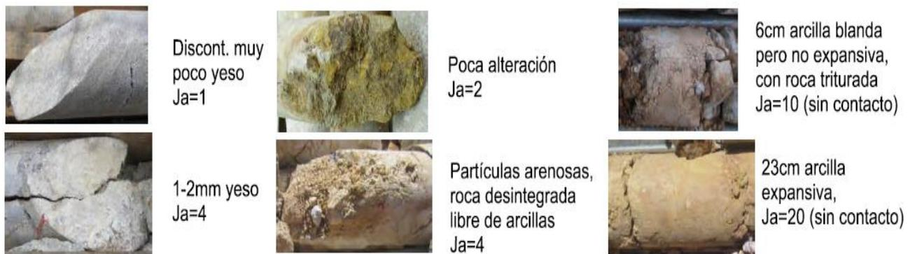
Ilustración 8 Ejemplos de identificación del parámetro  $J_a$  en discontinuidades (Piteau Associates, 2018)
