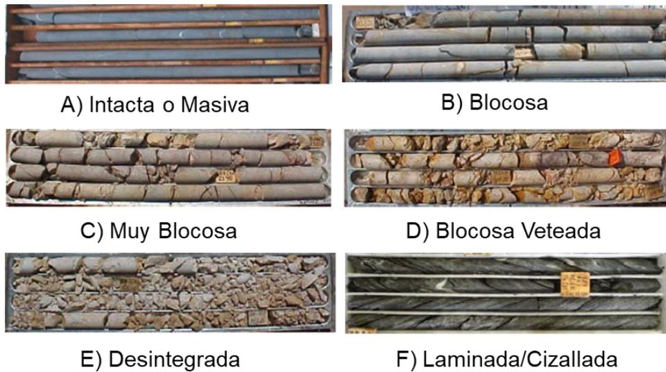
Ilustración 10 Caracterización del GSI en sondajes de acuerdo al Índice de Resistencia Geológica de Macizos Rocosos Fracturados (Piteau Associates, 2018)
