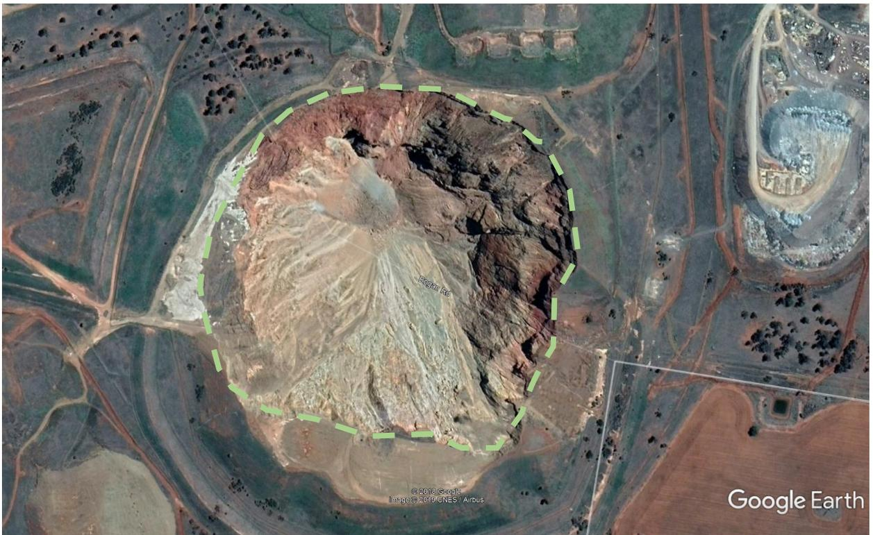
*Ilustración 27 Influencia en superficie de subsidencia en topografía plana (Mina Northparkes, Australia). Area de subsidencia delimitada por línea punteada.*
