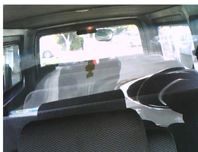
(c) Vista desde la parte central del asiento delantero con separación de mampara plástica.
