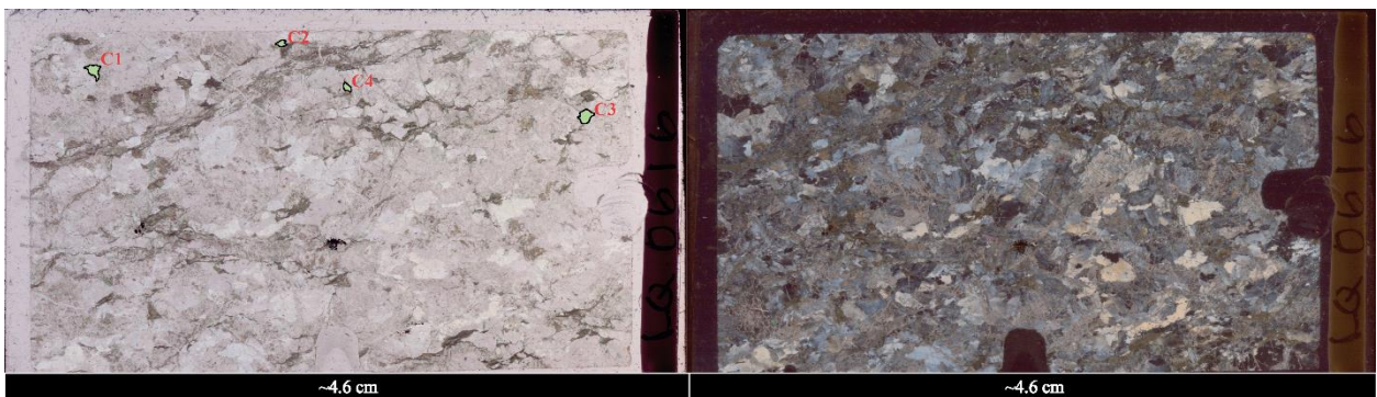
Figura 65. Mapas de corte de la muestra LQ0616. A la izquierda: en nícoles paralelos, se muestra la ubicación espacial de los cristales de clorita seleccionados para la aplicación de geotermómetros. A la derecha: en nícoles cruzados
