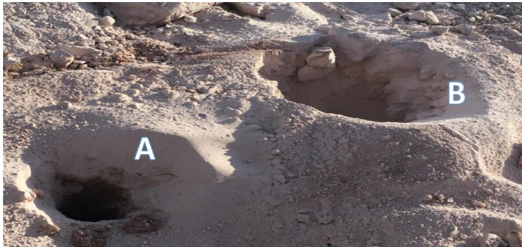
Ilustración 25: Pozo A realizado con Hole Control y pozo B realizado sin Hole Control. Fuente: (TEAS Chile).
